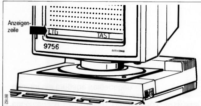
Die Geräte-Anzeigenzeile ist die abgesetzte, unterste Zeile des Bildschirms.
