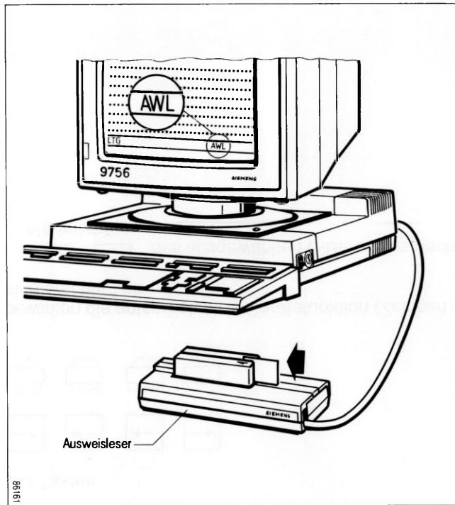
An die Datensichtstation kann ein Durchzugsausweisleser 9007-97 angeschlossen werden. Dafür muß ein Anschlußsatz in einen der beiden Einbauplätze der Steuereinheit gesteckt werden.
